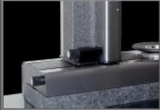
Mikrometrisches Feinverstellen der Achsen X und Z über zwei Handräder. Unerlässlich bei Messungen sowohl bei festem Fadenzug als auch bei der Autokollimation (Selbsterkennung) der Werkzeugschneide.
