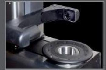
Kamerasystem für Messen und Inspektion. C-MOS Sensor, Doppellichtquelle mit rotem punktförmigen und toroidalem Licht. Optisches System mit niedriger F/Zahl.
