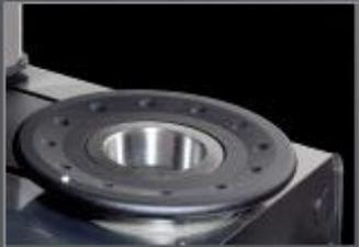
Drehbare austauschbare Spindel mit mechanischer Drehbremse. Zwei vorgespannte Doppelkugellager erlauben eine Konzentritätstoleranz innerhalb von max. 4 µm.
