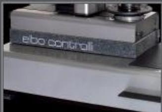
Basis und Fahrständer des Geräts sind aus geschliffenem Granit gefertigt. Die thermische Stabilität des Werkstoffs erlaubt es, das Gerät direkt in der Fertigung eines Werks aufzustellen. Mechanische Elemente des Geräts werden aus rostfreiem Stahl hergestellt.
