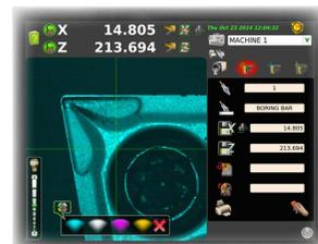
Inspektionsfunktion für eine genaue Kontrolle des Werkzeugzustandes. Für eine bessere Sicht können Sie die Helligkeitseinstellungen angepasst werden.
