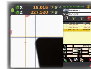
Td Six ist eine von Elbo Controlli neu entwickelte Software, um ermittelte Werkzeug-Abmessungen in eine Werkzeugtabelle einzutragen und generiert daraus eine Datei inklusive Werkzeugkorrektur.
