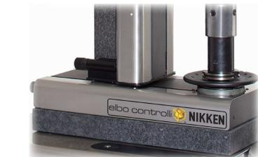
Basis und Fahrständer des Geräts sind aus geschliffenem Granit gefertigt. Die thermische Stabilität des Werkstoffs erlaubt es, das Gerät direkt in der Fertigung eines Werks aufzustellen. Mechanische Elemente des Geräts werden aus rostfreiem Stahl hergestellt.
