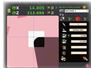
Neue elektronische Steuerung: ein leistungsstarker lüfterloser PC mit Linux-Betriebssystem für das integrierte Management der Funktionen Messung / Prüfung der Werkzeuge, Maschinen Referenzen und Werkzeugsätzen. Benutzerfreundlichkeit dank des integrierten Touchscreen.
