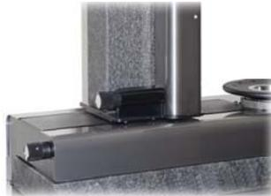
Mikrometrische Verstellung von X- und Z-Achse mit Hilfe von zwei Rädern, die für die genaue Einstellung der Messung mit einem festen Fadenkreuz notwendig sind.
