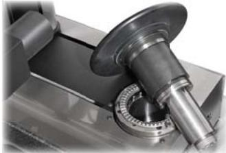
Auswechselbare, rotierende Spindel mit mechanischer Bremse. Zwei vorgespannte Kugelkäfte ermöglichen eine Rundlaufgenauigkeit innerhalb  $2\ \mu\text{m}$
