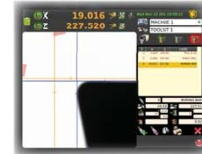
Td SIX ist eine neue Software, die von Elbo Controlli entwickelt wurde, um Werkzeugmaße zu erfassen, die in die Werkzeugtabellen einzugeben und eine Datei mit Werkzeugen zu erstellen.
