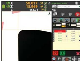
Fortschrittsanzeige des Messverlaufs während des automatischen Erfassungszyklus der Schneide durch Kreisdiagramm in Prozent.
