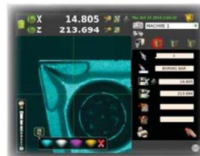
Inspektionsfunktion zur genauen Kontrolle des Werkzeugzustandes. Möglichkeit, die Helligkeit für eine bessere Visualisierung anzupassen. 4 verschiedene farbige Filter zum Hervorheben von Werkzeugschäden.
