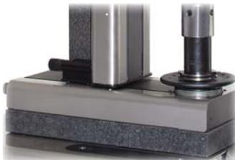
Basis und Säule aus geschliffenem Granit. Durch die thermische Trägheit dieses Materials kann die Maschine direkt in der Werkstatt platziert werden. Mechanische Elemente aus Edelstahl.
