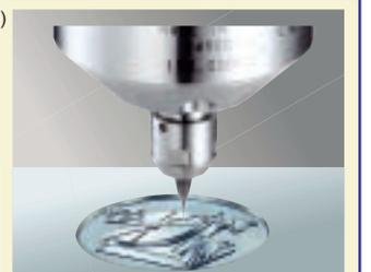
Das Formprofil wurde mit einem Ø0,2mm Schafffräser bei 150.000min<sup>-1</sup> ununterbrochen und prozessstabil bearbeitet.
