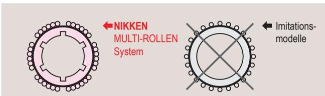
Die größere Menge der Nadelrollen ermöglicht das Bewegen gleicher Lasten mit geringer Kraft und weniger Abrieb der Lageroberfläche.
