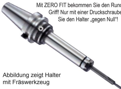
Mit ZERO FIT bekommen Sie den Rundlauf in den Griff! Nur mit einer Druckschraube regulieren Sie den Halter „gegen Null“!
