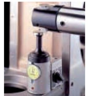
Ebenso geeignet für das Einstellen einer Bohrstanze.
