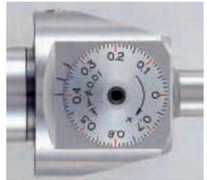
Die Ablesegenauigkeit beträgt 0,01mm, mit Hilfsskala 0,005mm. Eine Umdrehung entspricht 0,8mm vom Ø. 1 Teilstrich = 0,01mm vom Ø.
