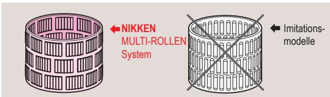
Wie die Querschnittsansicht zeigt, sind bei uns die Nadelrollen sauber in dichten Paketen angeordnet, im Gegensatz zur verstreuten Anordnung bei imitierten Modellen.
