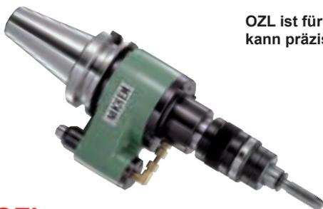
OZL ist für den Einsatz von Gewindeschneidern mit Kühlkanal konzipiert. Die Gewindeschneidtiefe kann präzise gesteuert werden. Die max. Drehzahl beträgt 2.000min<sup>-1</sup>.
