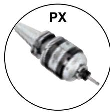
NIKKEN-Schnelllaufköpfe übersetzen die Spindeldrehzahl um das 4- bis 10fache. Dadurch kann sich eine Drehzahl bis zu 40.000min<sup>-1</sup> ergeben. So wird aus Ihrem Bearbeitungszentrum eine HighSpeed-Maschine. Das Planetengetriebe ist durch einen dynamischen Fluidprozess mikrofein geschliffen. Durch Verwendung der TiN-Spannmutter wird der Rundlauf stabilisiert.
