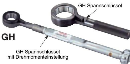
Der GH Spannschlüssel für HIGHSPEED-Werkzeuge hat einen Mechanismus ähnlich dem einer Ratsche. Mit einem leicht bedienbaren Hebel schaltet man auf Anziehen oder Losschrauben. So wird ein schneller und bequemer Werkzeugwechsel erreicht. Auf irgendwelche Nuten oder Mitnehmer an der Spannmutter kann der GH Spannschlüssel ganz verzichten.
